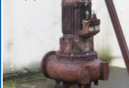
AW Tauchpumpe 590m³/h
